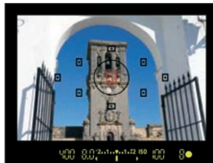
Il modulo AF dispone di 9 punti di messa a fuoco, dei quali il centrale a croce.
