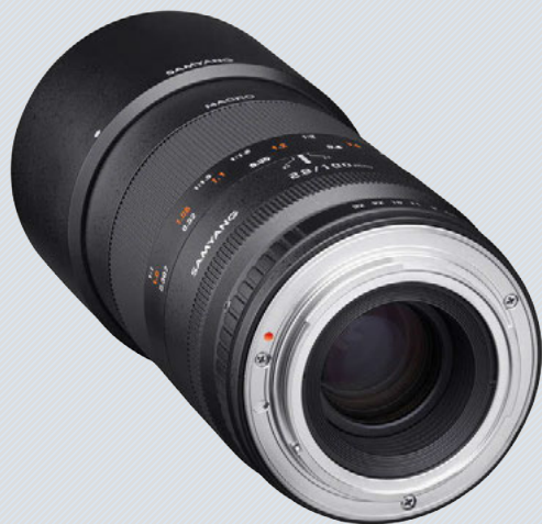
La baionetta del Samyang 100mm f/2.8 Macro è in metallo ed è disponibile per molti innesti. Mancano i contatti elettrici per la comunicazione con il corpo macchina.
